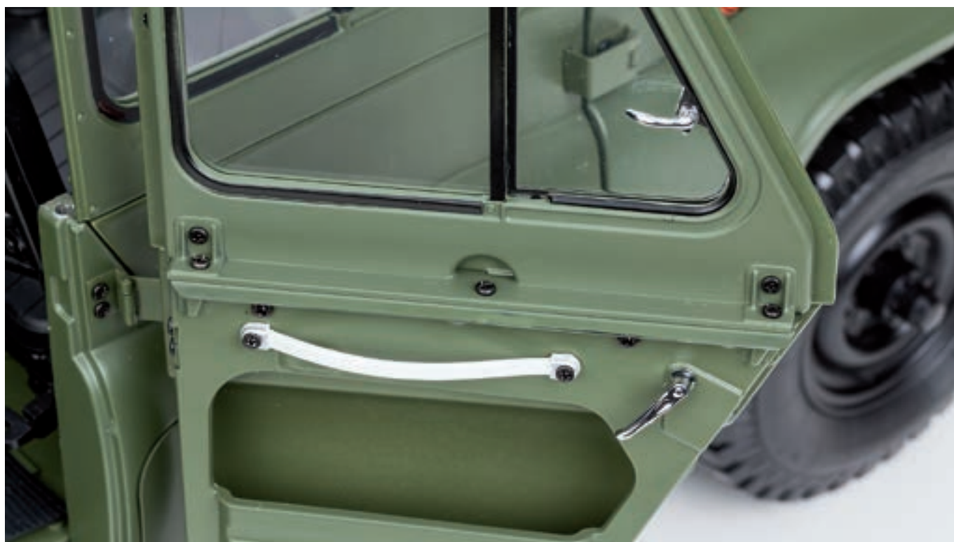
Шаг 3. Разместите собранную надставку поверх задней правой двери модели. Совместите центровочные элементы деталей и закрепите надставку при помощи трех винтов 1,7x4 (AP).
