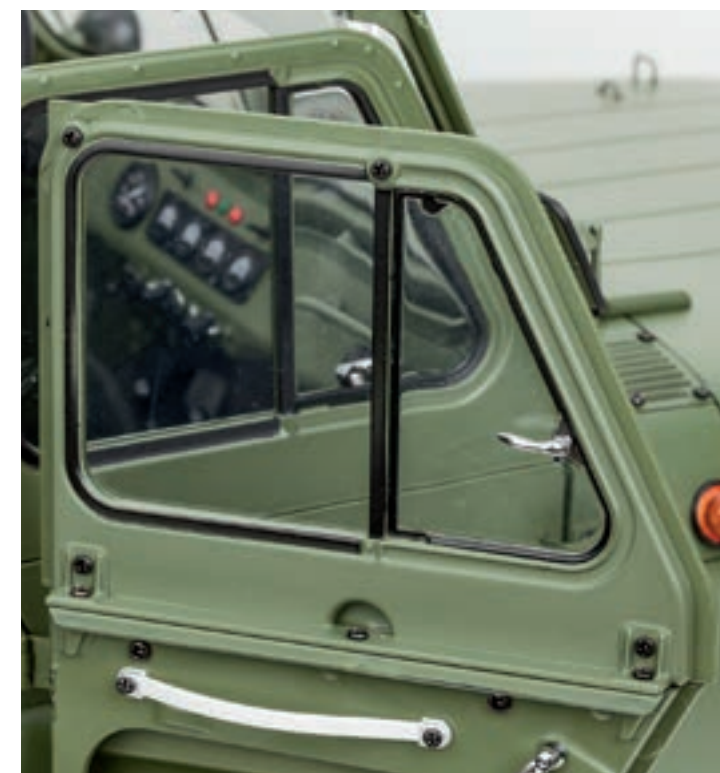
Шаг 4. Проверьте возможность открывания поворотного стекла двери. Для этого поверните ручку на рамке стекла двери вверх (фиксатор освободит рамку стекла), а заднюю часть стекла — в сторону от пассажира.
