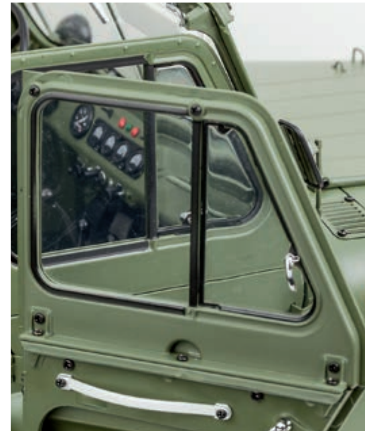
Шаг 4. Проверьте возможность открывания поворотного стекла двери. Для этого поверните ручку на рамке стекла двери вверх (фиксатор освободит рамку стекла), а заднюю часть стекла — в сторону от пассажира.
